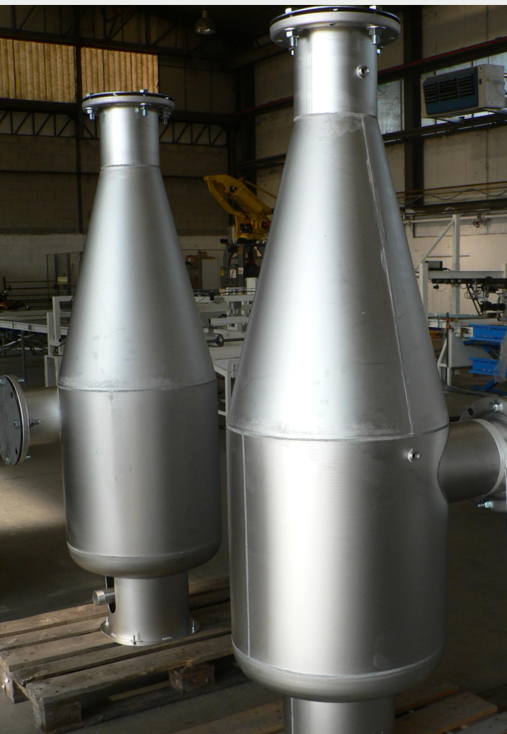
Fabrication de filtres HM 200 dans l'usine TEMIQ (Vaugneray - 69)
